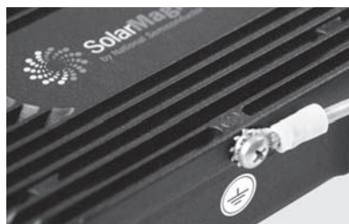
Fig. 7. Terminale aggraffato ad anello omologato UL con cavo flessibile di massa USE-2/RHW-2
