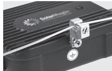
Figura 8. Lengüeta de tierra para ubicación húmeda listada por UL con cable de tierra en cobre desnudo
